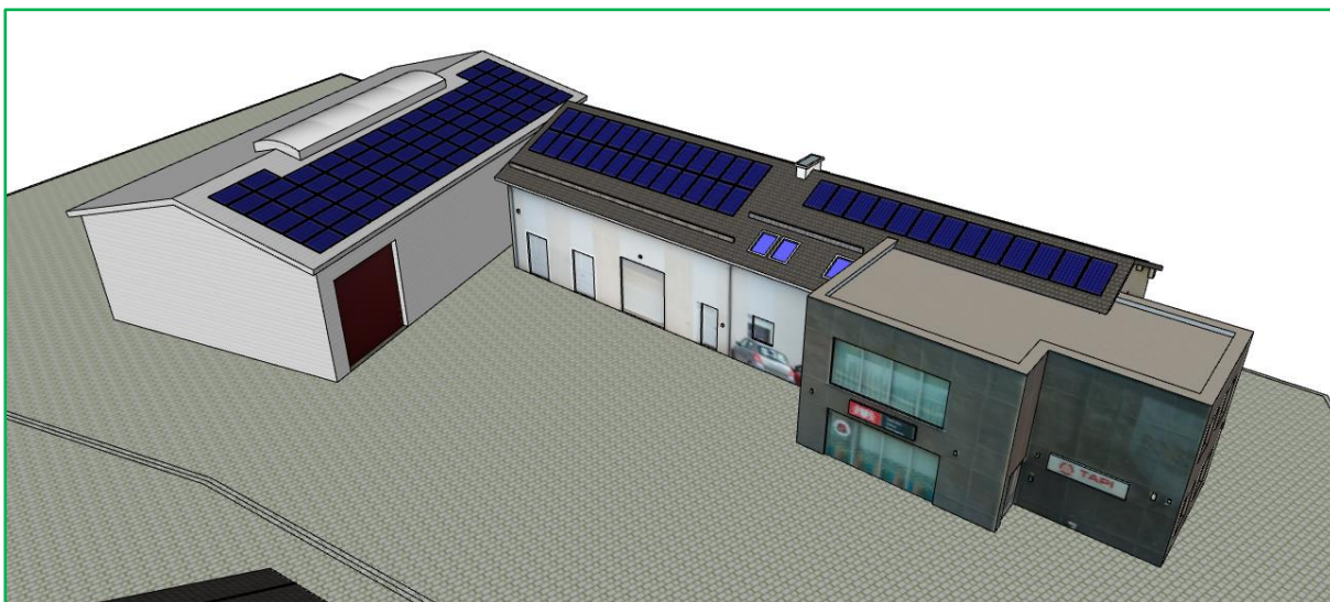
Rys. Konceptcja graficzna aksonometryczna mikroinstalacji fotowoltaicznej na zachodniej połaci Obiektu biurowego P.
